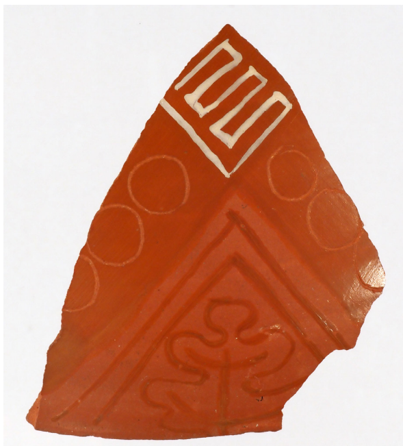
Abb. 5 Scherbenprobe nach der oxidierenden Brand- phase mit Ritzungen und Deckweiß | JGU Mainz, Sammlung Klassische Archäologie Inv. 440
